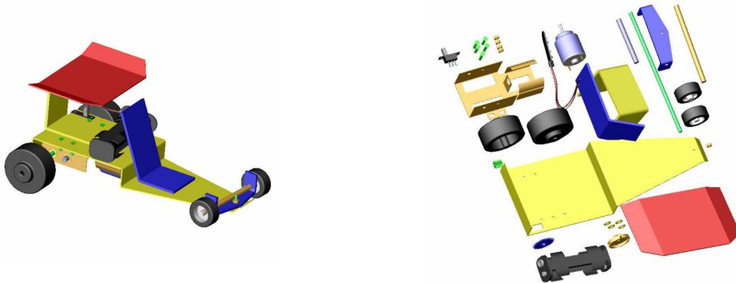
Il est constitué de PVC rigide appelé aussi PVC U. Le PVC U est un matériau correspondant parfaitement à ce que l'on attend en matière de matériau en classe de technologie. Il a une bonne usinabilité, il est esthétique... De plus, les pièces se collent très bien avec une colle PVC.
